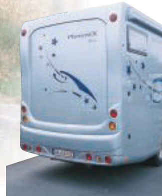
Am Heck des Liners sind GfK-Elemente auf das Alu-Sandwich gesetzt.
